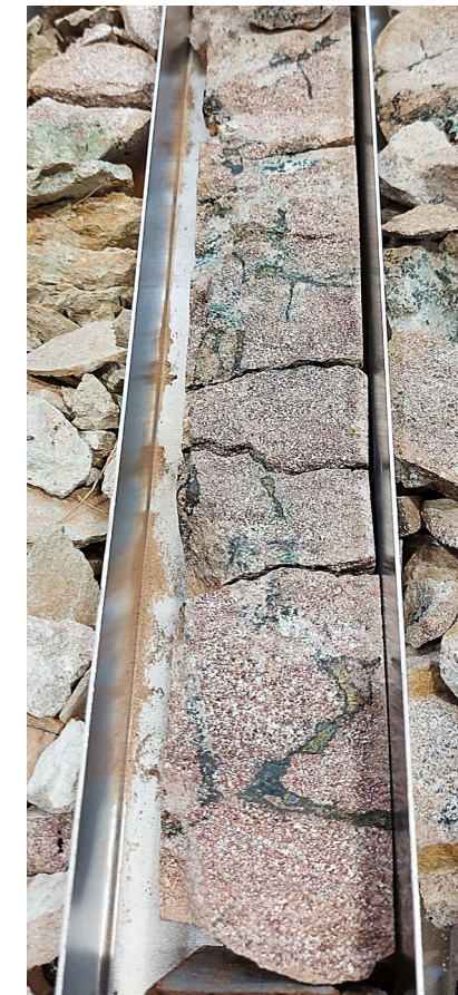
DH M350-250 @39m permafrost breccia Whyalla Sandstone Cattlegrid deposit
